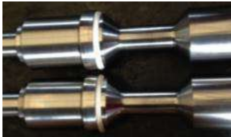
Spindle Ass'y Elwood 4" (Material SUS 431)
