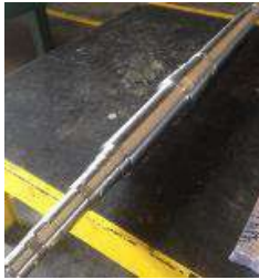
Shaft Pos.1 Baf Base Fan (Mat.SUS316)
